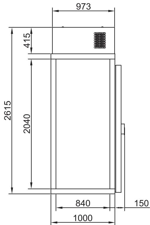
2. Камеры с полом и двумя дверными блоками. Выполняются как в среднетемпературном, так и в низкотемпературном режимах.
