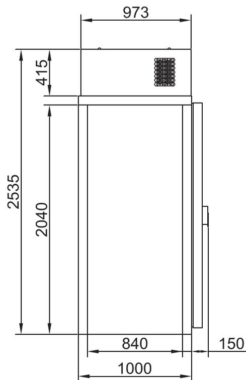
4. Камеры без пола с двумя дверными блокам. Выполняются в среднетемпературном режиме.
